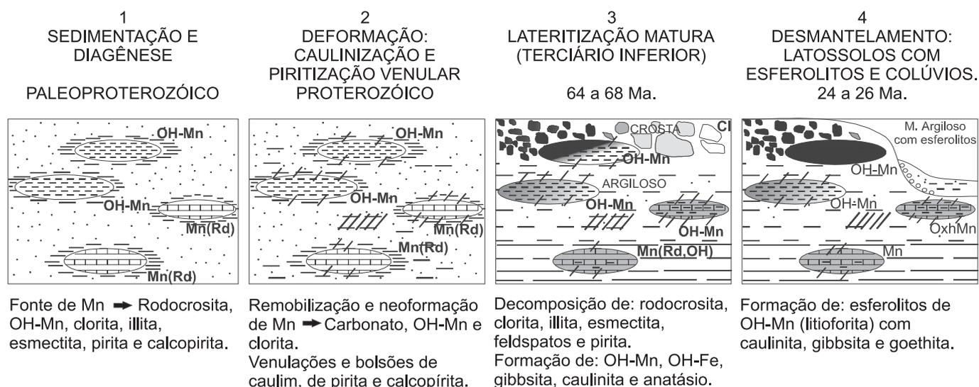
Figura 8.1 – Evolução geológica esquemática do depósito de manganês do Azul, Carajás.
