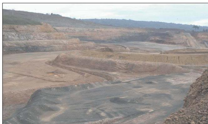
Figura 2.15 – Aspecto geral da frente de lavra da mina 1 em 2004, mostrando o domínio de siltitos vermelhos envolvendo vários corpos lenticulares de cor negra e constituídos normalmente de OH-Mn, ou seja minério de manganês, correspondendo em primeiro plano ao horizonte argiloso saprolítico e mesmo à rocha-mãe e bed-rock e aos fundos para o topo o horizonte argiloso mosqueado com a megalente de OH-Mn e finalmente a crosta laterítica. O fundo da cava estava à cota mínima de 472 m.
